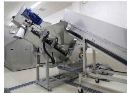
独自の機構で作業効率に優れた食品廃棄物の破碎・脱水・減容機
