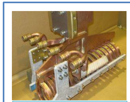
高周波加熱コイル：高周波誘導加熱による焼入など幅広い工程に活用されている
