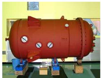
内部にフッ素樹脂シートライニング加工を施した半導体プラント等で使用される貯槽
