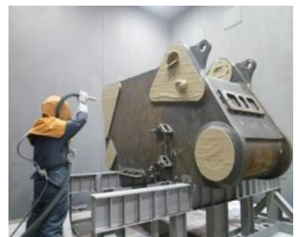
金属の小粒子を高圧で吹き付けて表面を研磨する金属加工
