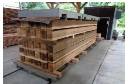
スギ平角の人工乾燥試験
