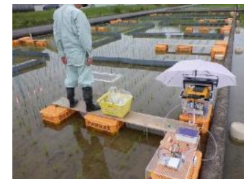
水田でのメタンガス採取調査
