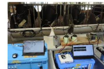
牛メタン産生量の測定法 (スニファー法)
