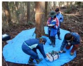
樹木根系の地中レーダー調査
