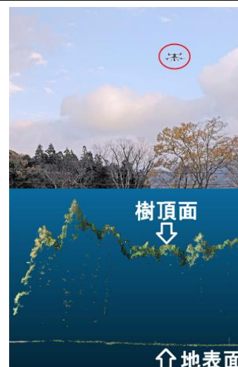
レーザドローン（赤丸内）による三次元点群データの取得（上）と取得データを基に作成したスギ林の断面図（下）
