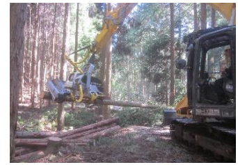
高性能林業機械による 木材の搬出
