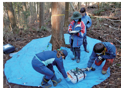
地中探査用レーダによる樹木根系の非破壊調査
