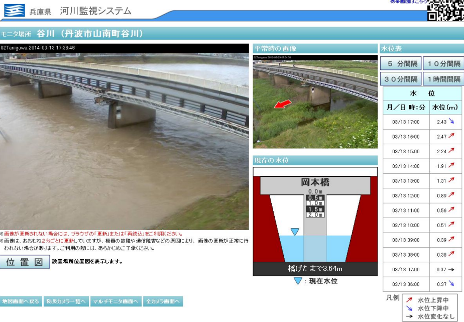
図 60 河川のリアルタイム監視画像例 (兵庫県河川監視カメラシステム URL: http://hyogo.rivercam.info/ )
