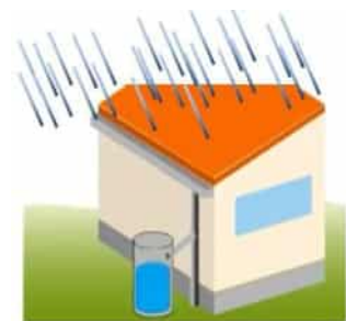
屋根に降った雨水を貯留
